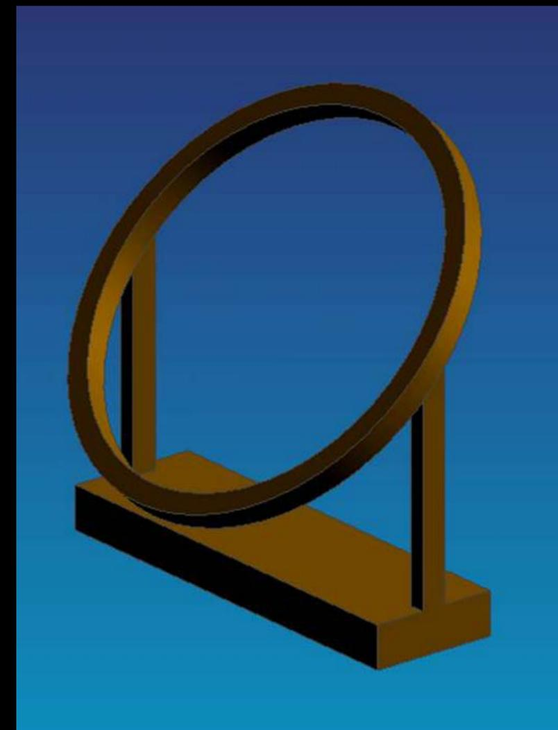
Гиппарх использовал для наблюдений равноденствий особый инструмент — экваториальное кольцо. Когда солнце находится на экваторе, в точках равноденствий, тень падает на прибор.
