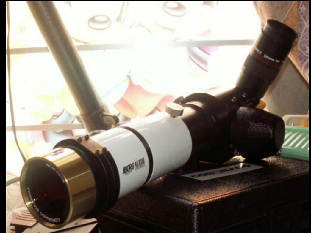
Пример любительского солнечного телескопа, оснащённого фильтром в линии H-альфа.
