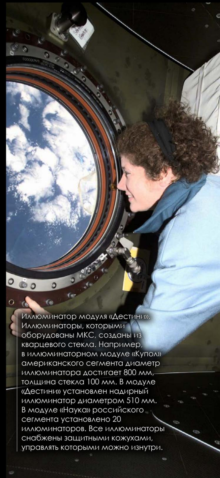
Иллюминатор модуля «Дестини». Иллюминаторы, которыми оборудованы МКС, созданы из кварцевого стекла. Например, в иллюминаторном модуле «Купол» американского сегмента диаметр иллюминатора достигает 800 мм, толщина стекла 100 мм. В модуле «Дестини» установлен надирный иллюминатор диаметром 510 мм. В модуле «Наука» российского сегмента установлено 20 иллюминаторов. Все иллюминаторы снабжены защитными кожухами, управлять которыми можно изнутри.
