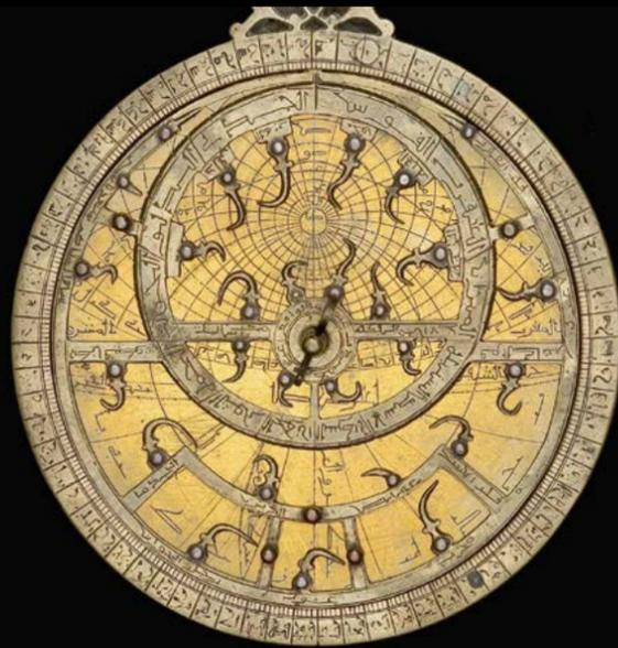
Средневековая арабская астролябия — один из древнейших астрономических инструментов для измерения горизонтальных углов и определения широт и долгот небесных тел, принцип работы основан на стереографической проекции.
