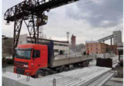
Погрузка готовых изделий на Зеленогорском заводе железобетонных изделий
