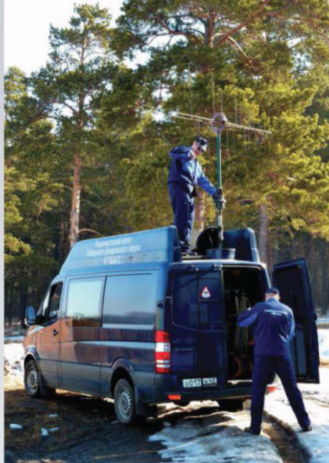
Специалисты группы радиоконтроля Кемерово готовят мобильный комплекс радиоконтроля «БАРС-МПИ» к работе
